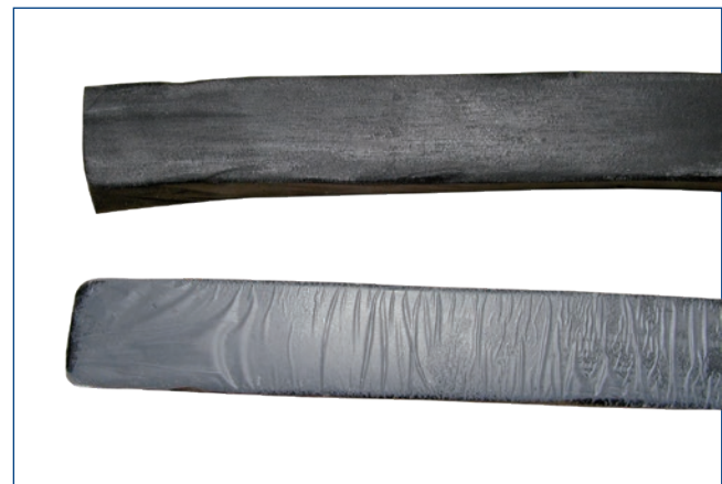
Vergleich Quellband mit und ohne Schutzhülle
